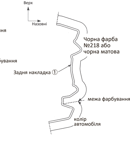
Секція б-б, детальний вигляд
